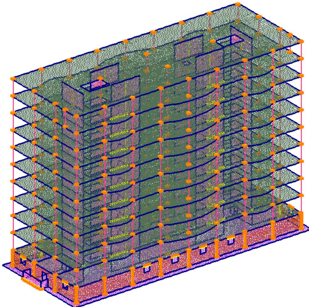
*Расчетная схема ЖБ каркаса в ВИЗОР (МКЭ-редактор ПК ЛИРА-САПР)*
